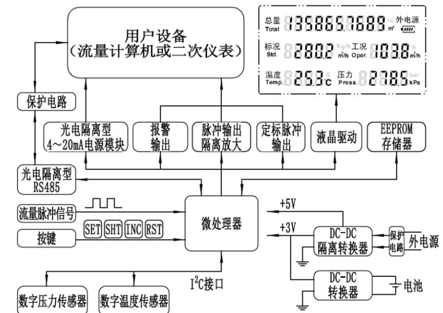
图 2 流量积算仪原理框图
