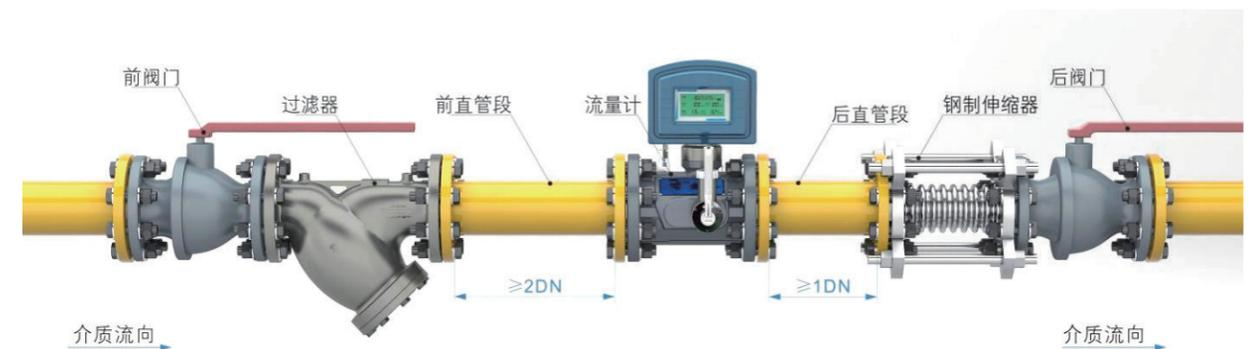
图 7 流量计水平安装示意图
