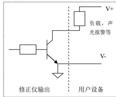
图 4 报警信号输出接线图
