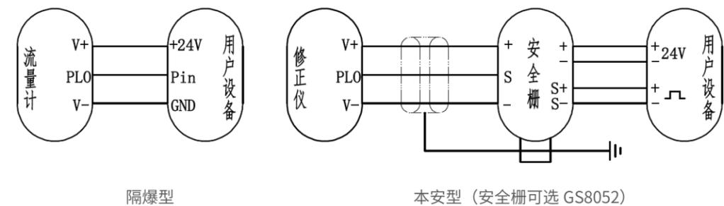
图 12-1 脉冲信号输出接线图
