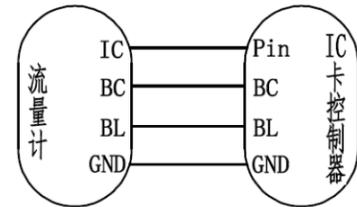
图 12-2 定标脉冲信号输出接线图
