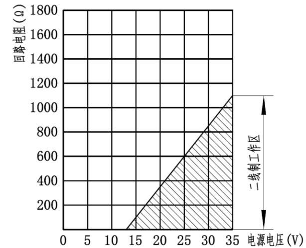
图 13 电源电压与回路电阻关系图
